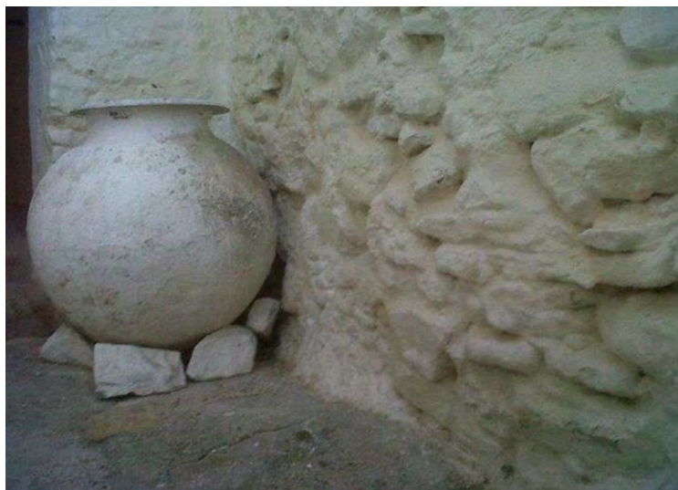
Fig. 1: Tinaja utilizada para apagar cal en su interior.
